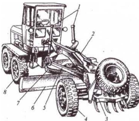
6 - гидроцилиндры; 7-балка; 4 и 8 - передние и задние колеса; 1 - отвал; 2 - поворотный круг;
