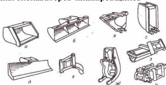
А) ковши - экскаваторный (*в*); планировочный (*б*); профилировочный (*а*); для дренажных работ (*г*); *д* - планировочный отвал; *е* - рыхлитель; *ж* - клещевой захват; *и* - уплотняющий каток; *з* - приспособление для боковогокопания
